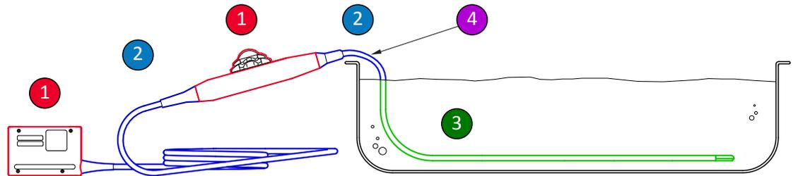
Zu reinigende und zu desinfizierende Abschnitte an einem TEE-Schallkopf
